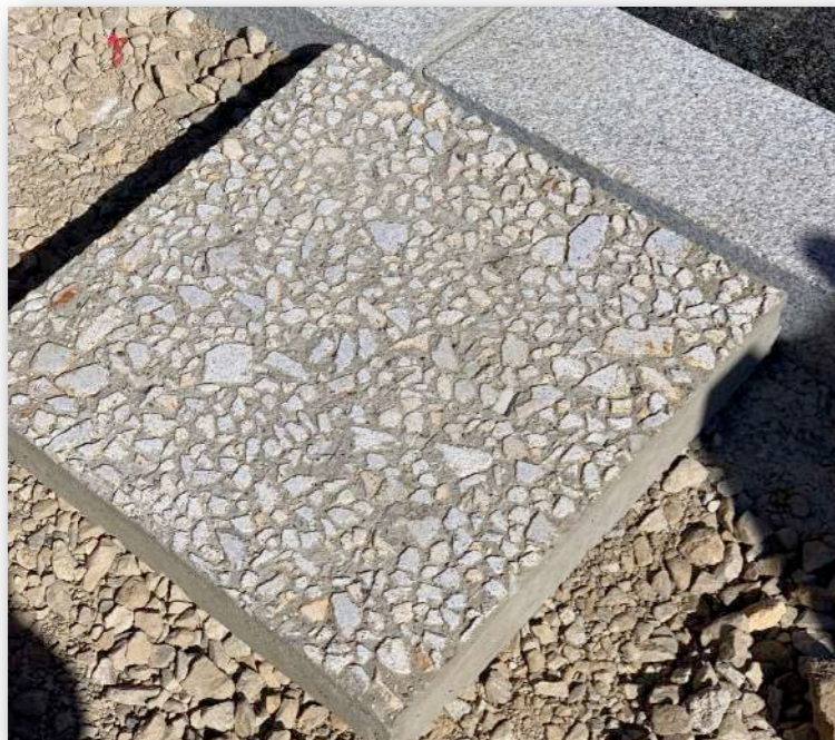
Béton désactivé aspect rustique à base d'agrégats de la carrière de Montregard (granitique) composition : 6/10 à 30% 20/40 à 70 %
